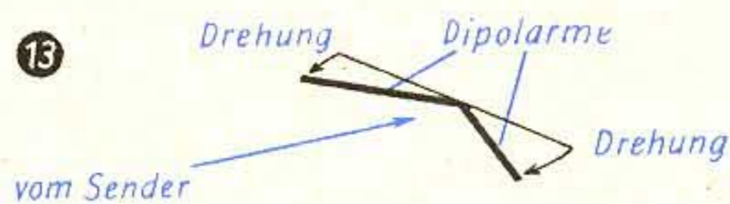
Abb. 13. Wirkung der Drehung (Anwinkelung) der Dipolarme zum Sender
